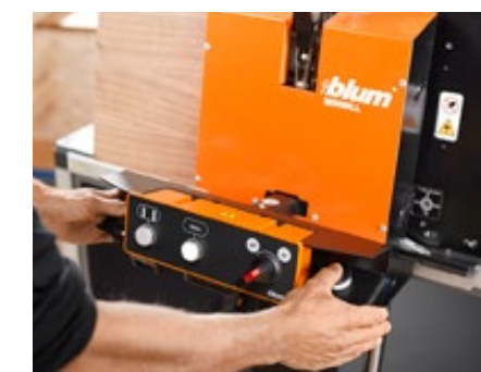
MINIMILL – фрезерування для силового механізму AVENTOS HKi.
